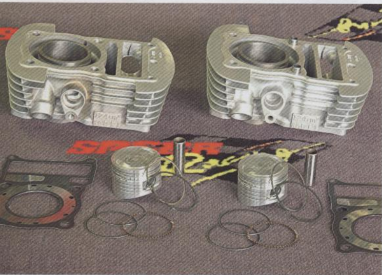
Aus dem Honda-Teileregale stammen die neuen Kolben mit acht Millimetern mehr Durchmesser, die Zylinder bohrt man Speer auf 50 Millimeter auf
